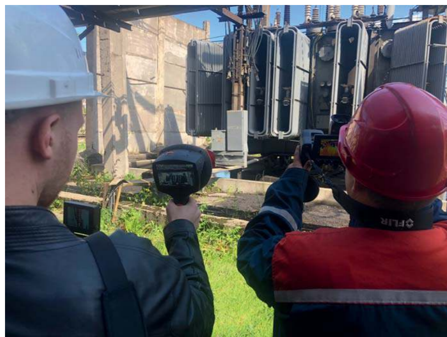
Рис. 1. Диагностика с помощью ультразвуковой NL-камеры и тепловизора
