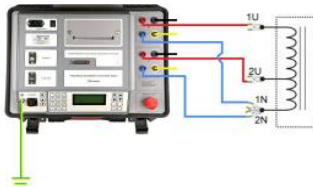
Схема подключения TRT 4x к однофазному автотрансформатору.
