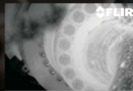
УТЕЧКА ПРИРОД. ГАЗА ЧЕРЕЗ КЛАПАН КОМПРЕССОРА
