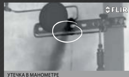
УТЕЧКА В МАНОМЕТРЕ
