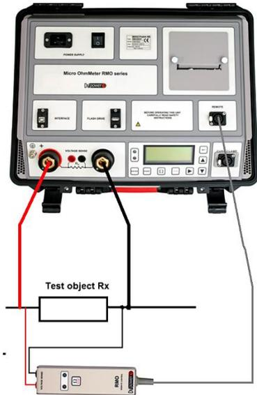
Рисунок 3 – Измерение с помощью блока дистанционного управления
