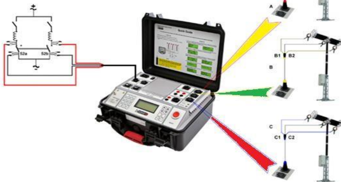
Подключение кабелей главных контактов и кабелей дополнительных контактов к тестируемому объекту
