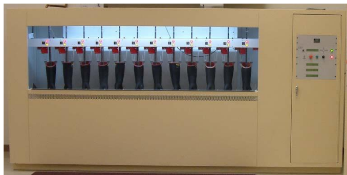
Серия L. Испытательный стенд на 12 перчаток.
