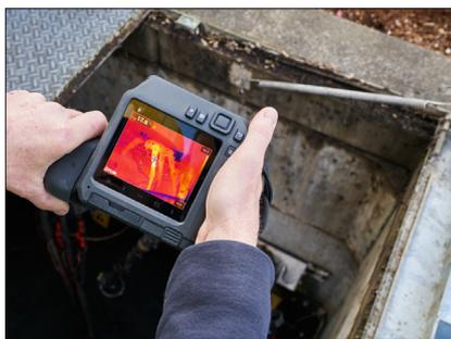
Поворотный (на 180°) оптический блок и яркий 4-дюймовый ЖК-экран обеспечивают удобство пользования камерами T500-Series в любых условиях.
