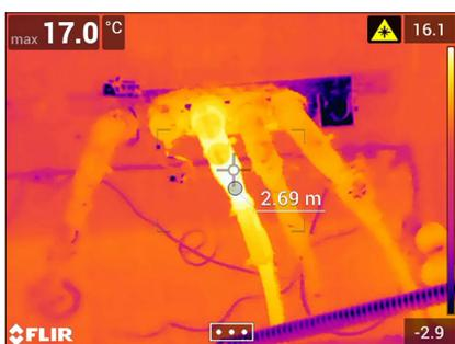
Лазерная автофокусировка и функция дальномера позволяют получать точные результаты, находясь за границей защиты от вспышки электрической дуги.
